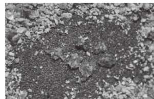
图 3 脱脂蚕蛹粉中疑似皮革粉（30×）
