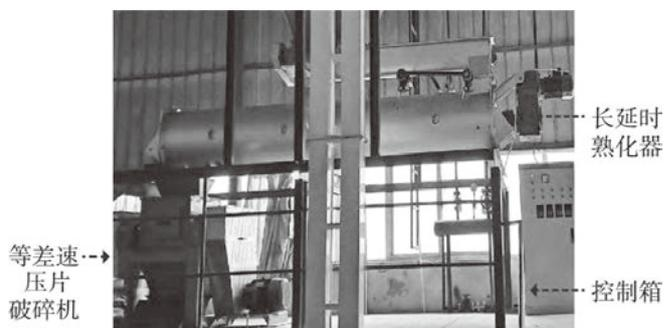
图1 玉米熟化压片破碎生产线
