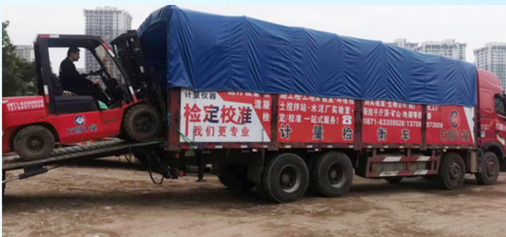
检衡车主要用于地磅的检定/校准
